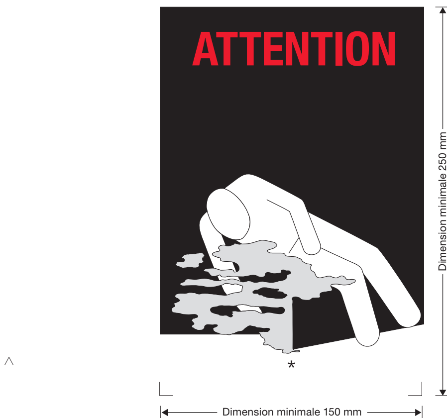
△ △ ⊗ Marque de mise en garde contre l'asphyxie pour les engins de transport
