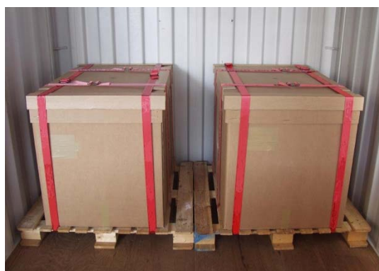
Figure 7.8 - Cargaison solidement assujettie à des palettes au moyen de saisines en textile
