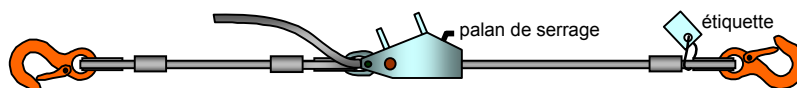
Figure 7.16 - Saisine en câble normalisée utilisée pour le transport routier munie d'un palan de serrage
