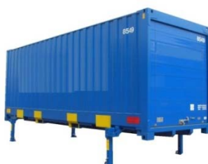
Figure 5.6 - Caisse mobile débarquée et positionnée sur béquilles
