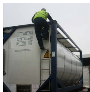
Figure 8.7 - Passer du passavant à l'échelle
