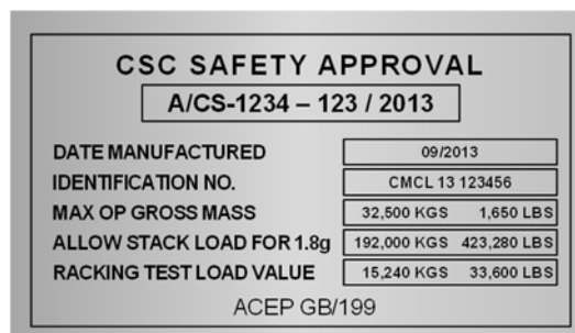
Figure 8.2 - Plaque d'agrément aux fins de la sécurité prévue par la Convention CSC avec marque ACEP
