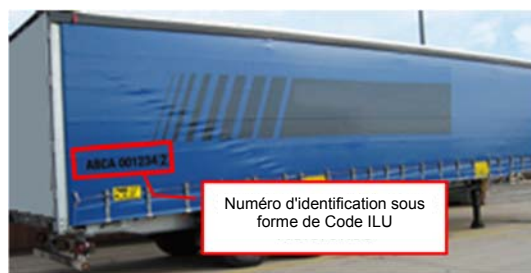
Figure 5.1 - Trois exemples de numéro d'identification d'engin de transport
