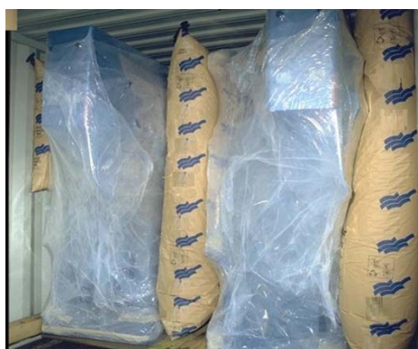
Figure 7.10 - Colis de forme irrégulière immobilisés à l'aide de sacs d'arrimage
