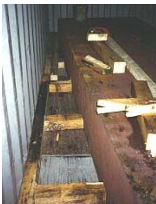
Figure 7.45 - Immobilisation transversale de plaques d'acier
