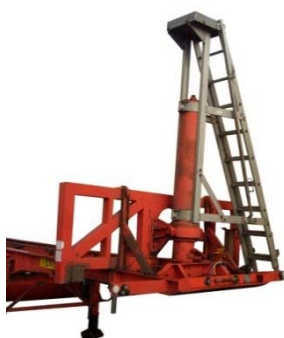
Figure 8.9 - Échelle d'accès fixée à la remorque
