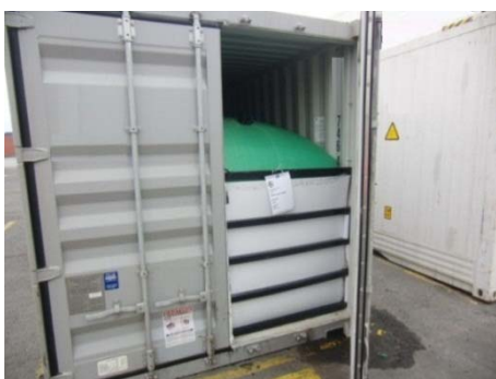
Figure 7.51 - Conteneur équipé d'une citerne souple
