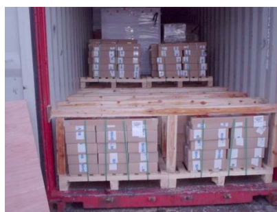
Figure 7.2 - Plancher temporaire en bois
