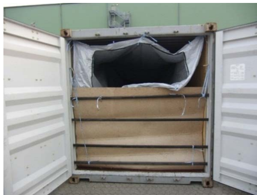
Figure 7.54 - Engin de transport doté d'un sac de revêtement pour le transport d'une cargaison solide en vrac
