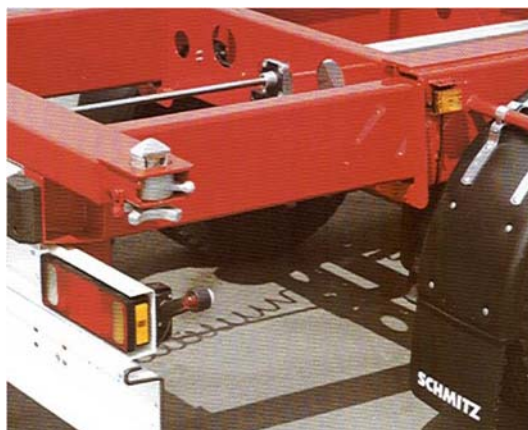
Figure 2.1 - Verrou tournant à bord d'un véhicule routier
